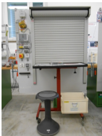
Ein Rolltormodell für praktische Übungen in der Lernfeldzone „Montage-/Installationstechnik“
